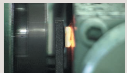
摩擦圧接により完全に一体化される
