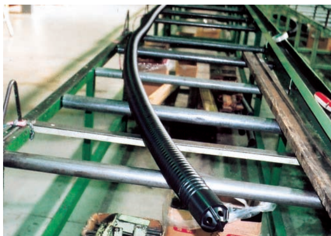
③ tendonの組み立て完了です。
