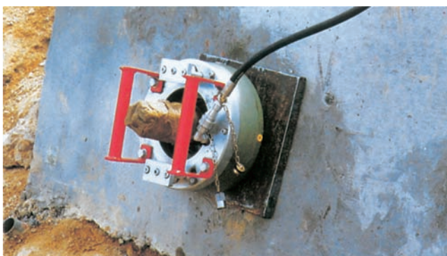
G w タイプロードセルによる残存引張り力測定状況
