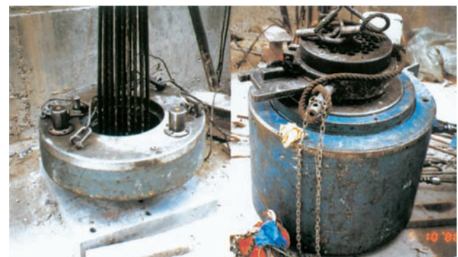
E 6 -42タイプ 850tonジャッキ (G w 850ロードセル使用)
