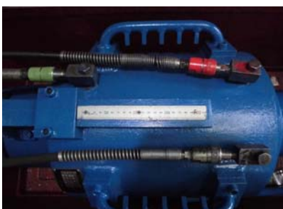
油圧のホース接続 (280tonジャッキ)
