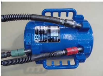
油圧のホース接続 (170tonジャッキ)
