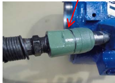
正しい接続状態 (170tonジャッキ)
